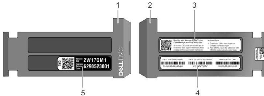
**Figure 20. Service Tag Diagram**
