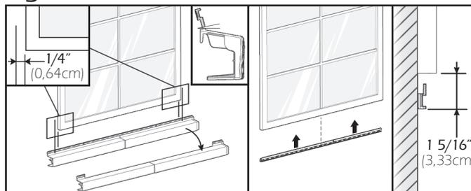
2-Installer le revêtement sous la fenêtre tel que spécifié dans son guide d'installation en s'assurant de laisser une distance de 1/4" (0,64cm) sous les têtes de clouage (Figure J).
