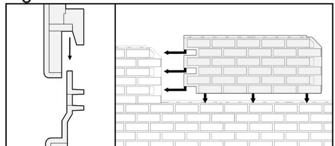
4-Lors de l'utilisation de moulures de finition (ex: moulure en J, moulure de coin extérieur, etc.) laisser un jeu d'environ 1/4"(0,64cm) entre la moulure et les TandoBrick (Figure 4). L'ouverture requise pour les moulures de finition est de 3/4"(1,91cm).
