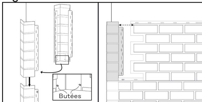
3-Pour le dernier coin, couper l'excédent de la pièce, puis installer le coin sur le mur (Figure J). Fixer le coin tel qu'indiqué précédemment et poursuivre l'installation des panneaux.
