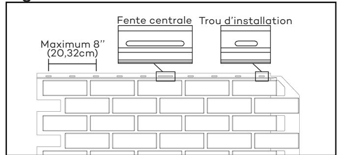
2-Ne jamais enfoncer les attaches complètement. Laisser un jeu d'environ 1/16"(0,16cm) entre la tête des attaches et le produit (Figure 2). Toujours utiliser des clous ou vis résistants à la corrosion ayant une tête de 0,4"(1cm) de diamètre et un corps de 0,150"(0,38cm) de diamètre, pénétrant la surface solide d'au moins 1 1/4"(3,18cm) et être dans un substrat solide d'une épaisseur d'au moins 7/16"(1,11cm).
