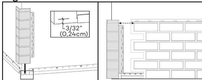
2-Installer le coin suivant en chevauchant le haut du coin précédent jusqu'aux butées inférieures situées au dos de la pièce. Fixer le coin tel qu'indiqué précédemment et débiter l'installation des panneaux. Faire une vérification de l'alignement de chaque coin avec les panneaux et ajuster au besoin (Figure I). Poursuivre l'installation des coins et panneaux jusqu'au haut du mur.
