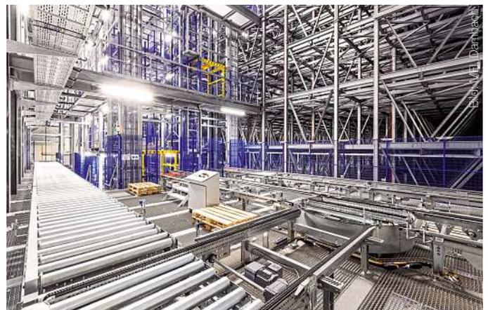
Die Fördertechnik übernimmt alle ein- und ausgelagerten sowie umgelagerten Paletten und leistet Bypass-Funktionen.
