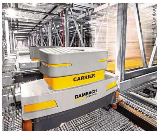
Insgesamt zwölf Carrier mit Shuttles bedienen die zwölf Ebenen des Multiflex-Lagers.
