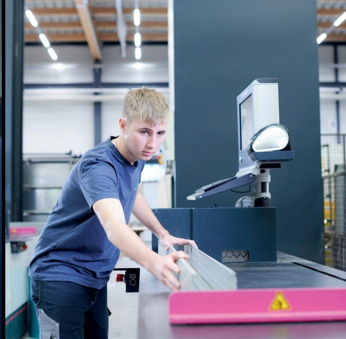
Schaltschrank-Flachteile die Perforex Bearbeitungszentren von Rittal zum Einsatz. Darin können Flachteile bis 2450 x 1600 mm eingespannt und alle im Steuerungsbau üblichen Materialien wie Stahl, Edelstahl, Aluminium, Kupfer und auch Kunststoff bearbeitet werden. Die Qualität der Ausbrüche ist sehr hoch. Die durchschnittliche Bearbeitungszeit mit der Perforex beträgt nur zwischen 15 und 20 Minuten pro Teil.
