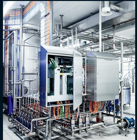
Typische Konstruktionsmerkmale wie die 30-Grad-Dachschräge oder das überhängende Dach mit waagerechter Tropfkante sorgen für schnelles und sicheres Abfließen von Flüssigkeiten.
