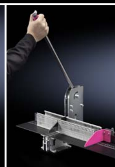
Manueller Verdrahtungskanalschneider MC125, siehe Seite 30
