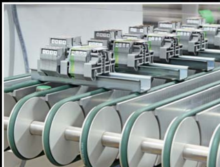
Sortiereinheit und Pufferlager für bearbeitete Klemmenleisten
