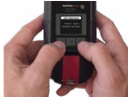
Les alertes rouges sont envoyées immédiatement au personnel de surveillance. Lisez les informations sur l'écran de votre G7. Appuyez simultanément sur les flèches du haut et du bas et maintenez-les enfoncées pour mettre le son et les vibrations en sourdine. Cette opération n'entraîne pas l'annulation de l'alerte rouge envoyée au personnel de surveillance.
