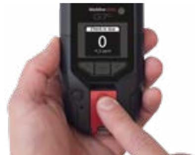
Wenn Sie in Sicherheit sind, drücken Sie die rote Hebelstaste. Wenn Sie die Hebelstaste nicht innerhalb der konfigurierten Zeit drücken, gibt ihr gelbes Rückmeldesignal einen roten Alarm an das Überwachungspersonal weiter.
