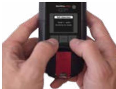
Rote Alarmsignale werden umgehend an das Überwachungspersonal weitergeleitet. Lesen Sie die Hinweise auf Ihrem G7-Display. Halten Sie die Auf- und Ab-Pfeiltasten gleichzeitig gedrückt, um den Ton und die Vibrationen stumm zu schalten. Dadurch wird der an das Überwachungspersonal gesendete rote Alarm nicht abgebrochen.
