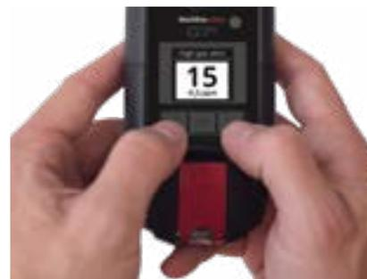
Verlassen Sie den Bereich und befolgen Sie das Notfall-Sicherheitsprotokoll. Lesen Sie die Hinweise auf Ihrem G7-Display. Halten Sie die Auf- und Ab-Pfeiltasten gleichzeitig gedrückt, um den Ton und die Vibrationen stumm zu schalten. Signaltöne und Vibration kehren nach einer Minute wieder zurück. Dieser Vorgang setzt sich fort, bis die Gasmengen oder Durchschnittswerte gesunken sind oder wieder akzeptable Konzentrationen vorliegen.
