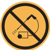
Dieses Symbol weist darauf hin, dass Hochdruckreiniger zum Reinigen des Gerätes nicht verwendet werden dürfen.
