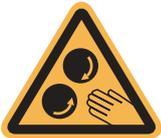
Dieses Zeichen weist auf Gefahren durch rotierende oder sich bewegende Maschinenteile durch die laufende Sammelwalze am Gerät hin.
