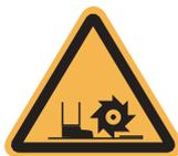
Dieses Symbol weist auf mögliche Gefahren durch das Anlaufen der Sammelwalze bei Betätigung des Bedienhebels hin.
