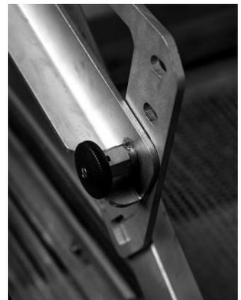
*Tipp: Wenn alles korrekt ausgeführt wurde, lassen sich die schwarzen Rastpins (Bild) mühelos öffnen und schließen um die Verstellbarkeit des Griffbügels zu gewährleisten.*
