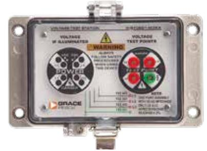
La VTS se puede conectar directamente al punto de trabajo para permitir la verificación visual del voltaje desenergizado y la medición del voltaje de CA/CC tanto de fase a fase como de fase a tierra usando un medidor. Los dos dispositivos se conectan independientemente a la misma fuente, lo que proporciona redundancia para mayor seguridad. El dispositivo debe ser instalado por un trabajador electricista calificado cumpliendo con todos los requisitos reglamentarios e instrucciones del fabricante.
