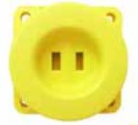
Con estos instalados en la puerta o brida de un gabinete eléctrico usando un sacabocados estándar de 1/2" o 30 mm y etiquetas con los procedimientos específicos del sitio, los trabajadores pueden llevar a cabo una prueba de presencia de voltaje usando una pluma detectora de voltaje sin contacto (NCVD) con la clasificación adecuada CAT III/CAT IV durante el LOTO mecánico.
