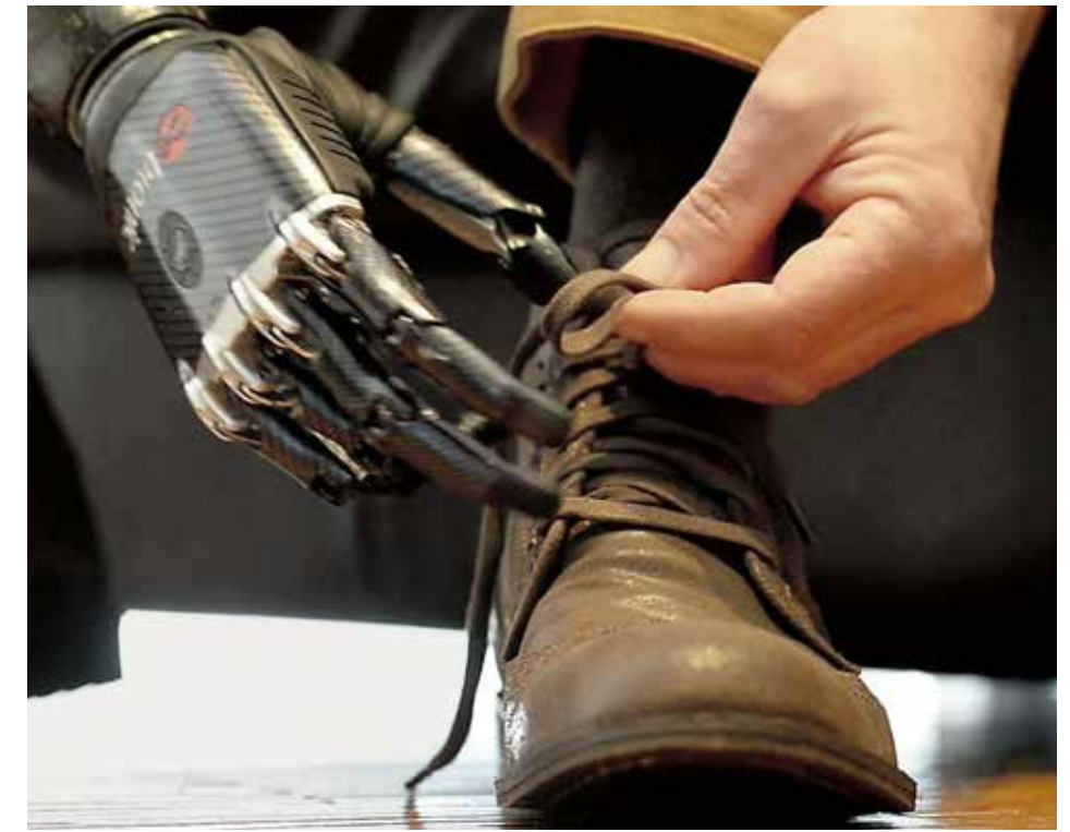
A destra: l'arto protesico Bebionic3, creato da RSL Steeper, è stato perfezionato al punto da permettere attività di manualità fine, come allacciarsi le stringhe delle scarpe. È stato inoltre rinforzato con acciaio inossidabile e titanio e dotato di cuscinetti che lo isolano da calore ed elettricità Right: the Bebionic3 prosthetic hand created by RSL Steeper is so fine-tuned that it allows tricky manual actions such as tying shoelaces. Reinforced with stainless steel and titanium, it is also fitted with pads insulated against heat and electricity
