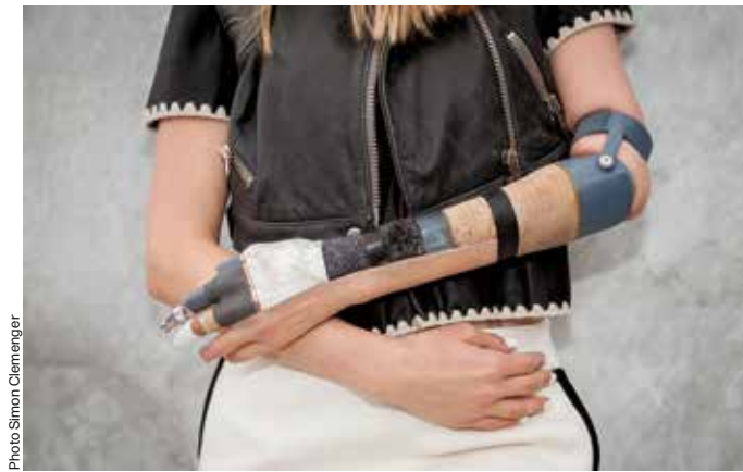
Sopra: Kelly Knox in posa con il suo braccio Materialise, sviluppato con Sophie de Oliveira Barata e Dani Clode, combinando stampa 3D, fresatura CNC, intaglio a mano e scultura. Sotto: il braccio bionico dello sciatore Danny Letain sviluppato da un team d'ingegneri della Simon Fraser University, Canada
