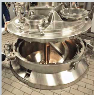
Hovedpladen løftes automatisk
