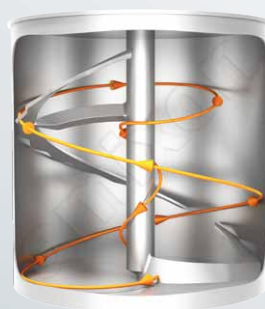
Opadgående bevægelse i blandekammerets periferi, nedadgående bevægelse i midten.
