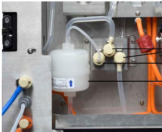
Conexiones rápidas del conducto fluídico
