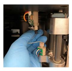
Suivez la tubulure vers le bas, de l'écrou noir jusqu'à l'écrou en plastique beige. Dévissez l'écrou beige et tirez-le délicatement avec la tubulure en dehors du SIP.
