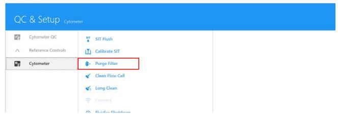
La vanne de ventilation raccordée au filtre du liquide de gaine s'ouvre alors, libérant les éventuelles bulles d'air piégées dans le filtre.
