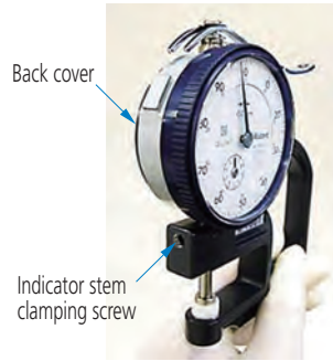
ข้อควรระวัง: ห้ามคลายสกรูยึดแกนเลื่อน (indicator stem clamping) ยกเว้นต้องการเปลี่ยนอินดิเคเตอร์
