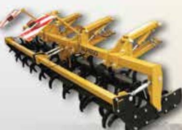
Faltbare Franter-Walzen H-40 mit HYDRAULISCHER Tiefe-Einstellung für die KX Modelle ( $\varnothing$  195mm)
