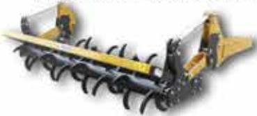
Franter-Walzen M-10 mit MECHANISCHER Tiefe-Einstellung für die KD - KE - K1 Modelle ( $\varnothing$  140mm)
