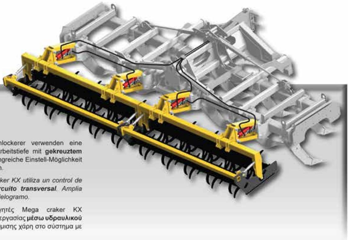
Die MEGA Craker KX Tiefenlockerer verwenden eine Vorrichtung zur Kontrolle der Arbeitstiefe mit **gekreuztem hydraulischen Kreislauf**. Umfangreiche Einstell-Möglichkeit Dank dem neuen Parallelogramm.
