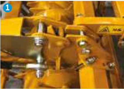
Sistema di sgancio rapido della barra di semina dall'erpice.
