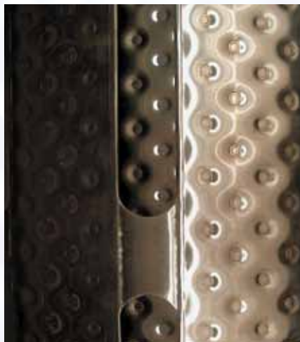
Condensador de evaporador de trajeto curto em padrões de higiene
