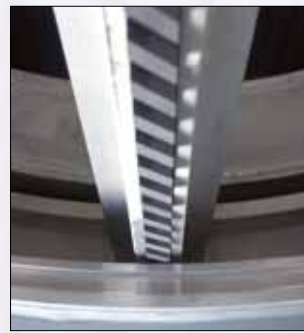
Rotor com PTFE movido radialmente ou elementos limpadores de grafite
