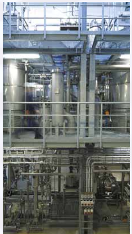
Planta de evaporação de trajeto curto para concentração de ácido graxo Ômega-3
