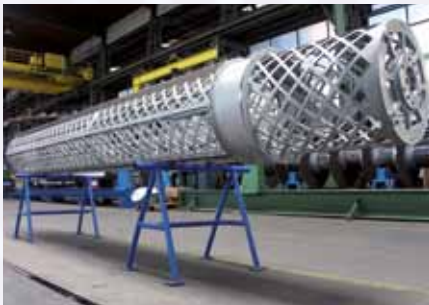
Rotor com elementos limpadores PTFE movidos radialmente
