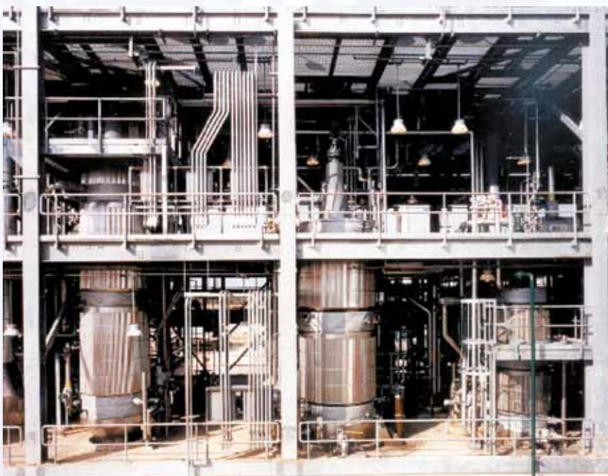
Planta de evaporador de trajeto curto e de película fina de três fases para a destilação de Diisocianato de isoforona.
