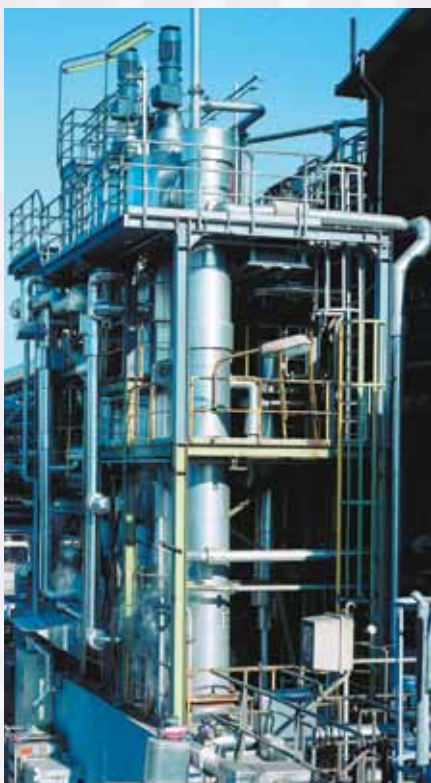
Planta de evaporação de película fina de duas fases para concentração de resina
