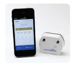
Protimeter BLE è un dispositivo compatto che misura e registra l'umidità relativa, la temperatura e il contenuto di umidità nei materiali da costruzione.
