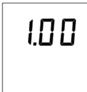
Lassen Sie beide Tasten los, sobald die Versionsnummer angezeigt wird. Das Gerät wechselt in den Einstellungsmodus.
