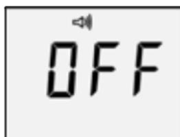
Si la unidad no detecta ninguna pulsación durante 2 segundos en la pantalla de ajustes, avanza hasta el siguiente ajuste.
